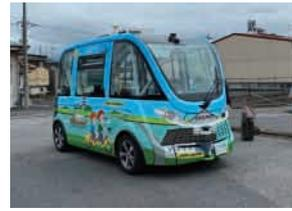
境町で実際に運行をしている自動運転バス。無人での運行が可能ですが、法律の規制上、オペレーターが1名乗車して運行を行っています。
